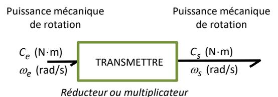
**Réducteur et multiplicateur adaptent la puissance mécanique de rotation.**
