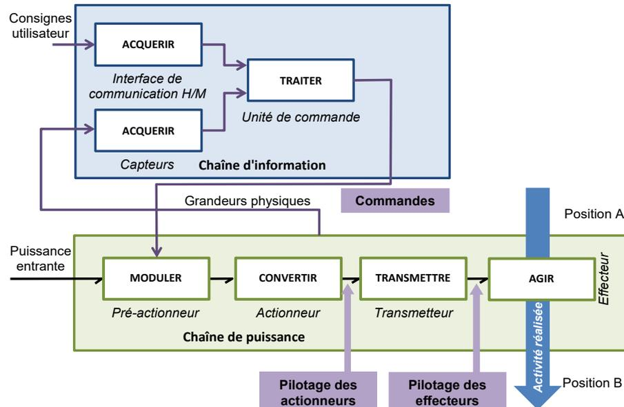
La description de la chaîne de puissance permet, pour chaque transmetteur, de définir une grandeur cinématique d'entrée (grandeur flux de la puissance d'entrée) et une grandeur cinématique de sortie (grandeur flux de la puissance de sortie).
