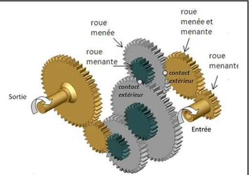
Dans un train d'engrenage, on qualifie de **roue menante** toute roue **motrice** lorsque **l'entrée est motrice**, et de **roue menée** <sup>(1)</sup> toute roue réceptrice.
