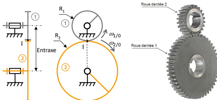
(2) La plus petite des roues dentées est appelée parfois « pignon » et la plus grande est appelée « roue » ou « couronne » dans le cas d'un engrenage intérieur.
