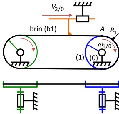
Par adhérence (si courroie lisse) ou par obstacle (si courroie crantée ou chaîne).
