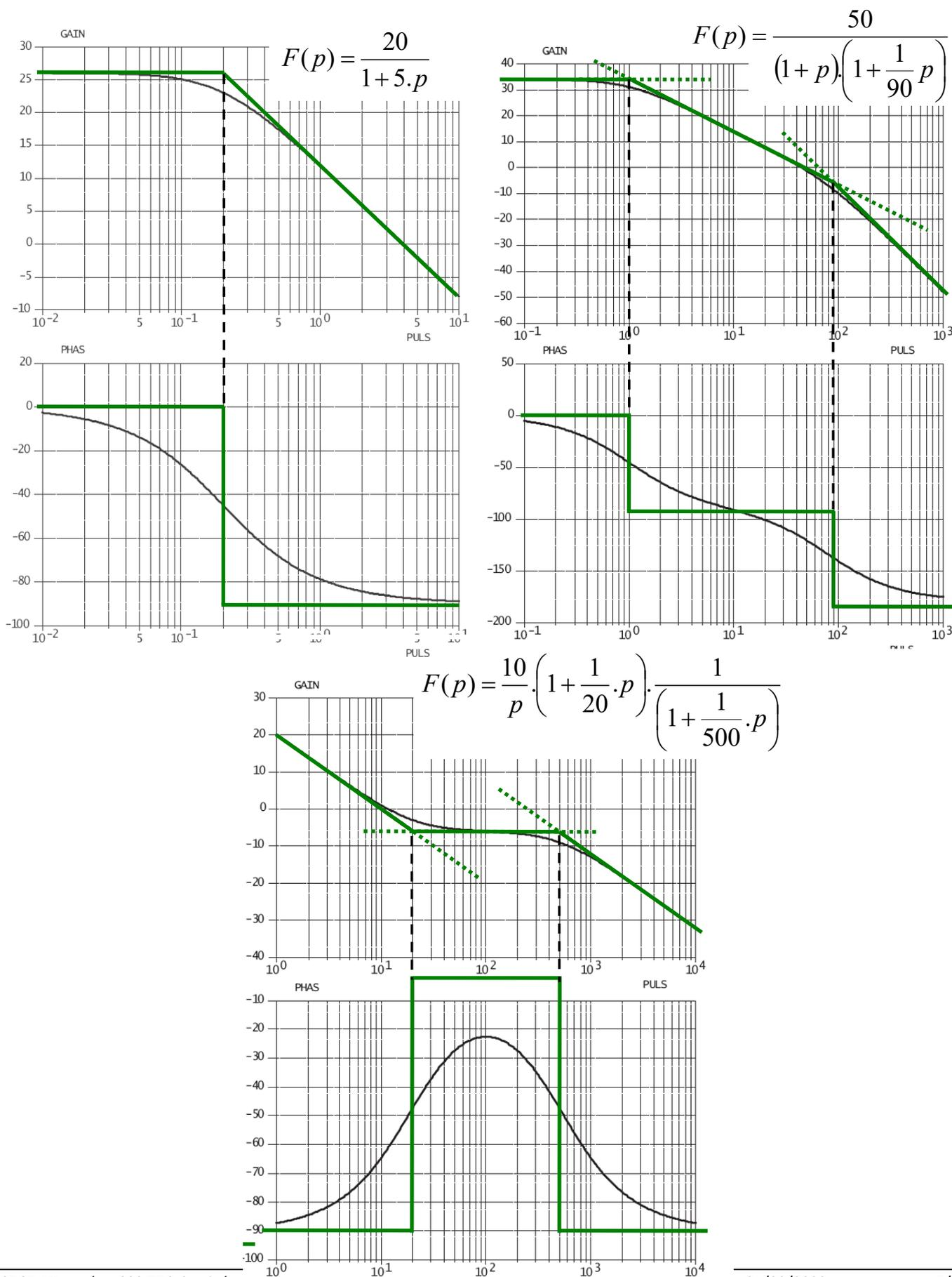
**Q1 :** Sur les diagrammes de Bode précédents, tracer les diagrammes de Bode asymptotiques puis identifier les fonctions de transfert correspondantes.
