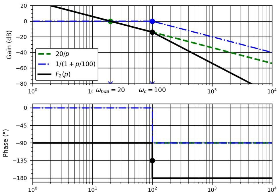
On peut obtenir directement le diagramme asymptotique de  $F_2(p)$  ci-après en partant, pour le gain, des basses fréquences et en changeant la pente à  $\omega_c$ .
