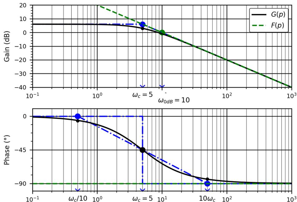
Pour le diagramme de gain de l'intégrateur  $F(p)$  : placer une droite à -20 dB/décade passant par le point  $(K, 0\text{dB})$ .
