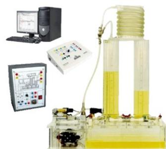
Le capteur utilisé est un capteur de pression dont la grandeur de sortie est adaptée pour donner une image de la hauteur d'eau en mètre.
