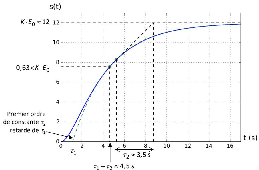
Q9 - Déterminer la fonction de transfert et les caractéristiques de la fonction
