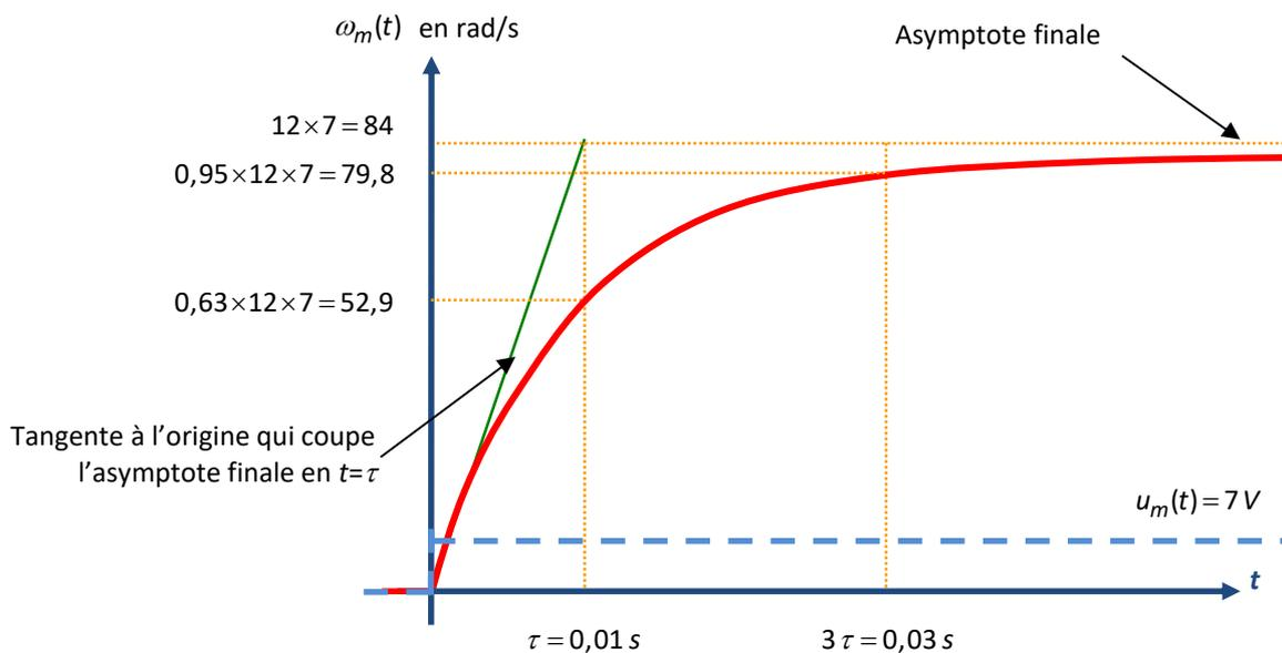
Q3 : Déterminer un modèle de comportement du hacheur  $\frac{U_m(p)}{C(p)}$ .
