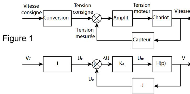
Le chariot est actionné par un moteur électrique piloté par sa tension d'entrée  $U_m$ . Cette tension est obtenue à l'aide d'un amplificateur fournissant une tension  $U_m$  proportionnelle à la tension de commande  $\Delta u$  (gain :  $K_A = 500$ ). Un capteur de vitesse mesure la vitesse  $V$  et renvoie une information de tension  $U_e$  proportionnelle à la vitesse  $V$  (gain :  $J=0,3V.s/m$ )
