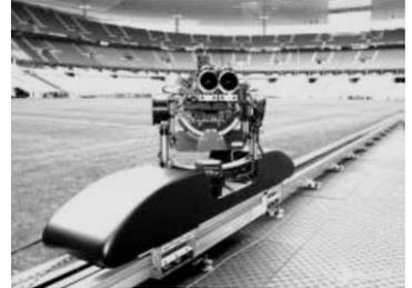
Un capteur optique permet de mesurer la position de la caméra par rapport au coureur. Un ordinateur détermine la consigne de vitesse nécessaire pour suivre le coureur, transmise sous forme de tension de commande à l'asservissement du chariot.
