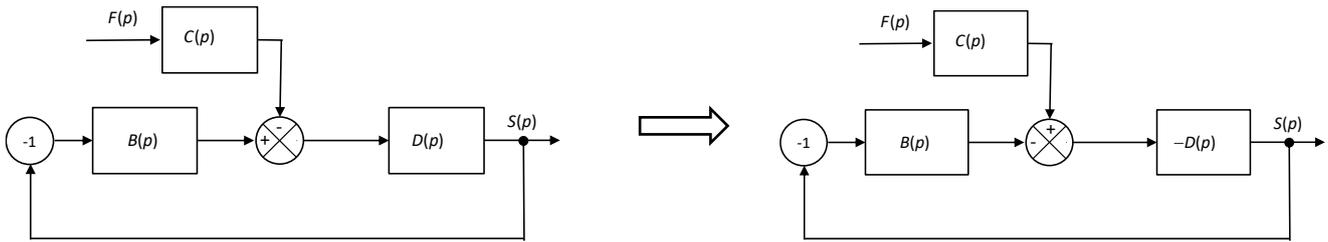
$$S(p) = C(p) \frac{-D(p)}{1 + D(p)B(p)} F(p), \text{ d'où } \left. \frac{S(p)}{F(p)} \right|_{E(p)=0} = \frac{-C(p)D(p)}{1 + B(p)D(p)}$$
