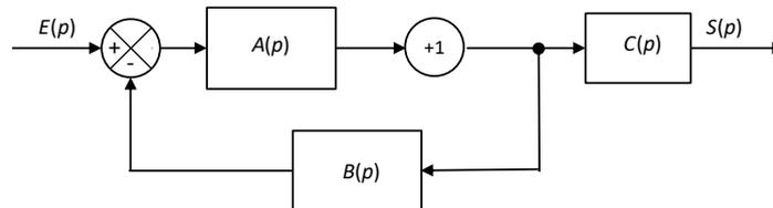
$$S(p) = \frac{A(p)}{1 + A(p)B(p)} C(p) E(p), \text{ d'où } \left. \frac{S(p)}{E(p)} \right|_{F(p)=0} = \frac{A(p)C(p)}{1 + A(p)B(p)}$$
