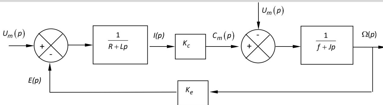
**Q2 :** Ce schéma comporte une boucle et des soustracteurs. Est-ce un système asservi ?
