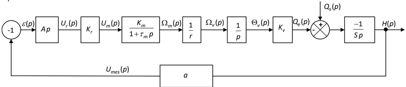
La chaîne directe est entre le comparateur et le point de prélèvement. Elle ne comprend que la fonction  $\frac{-1}{Sp}$ .
