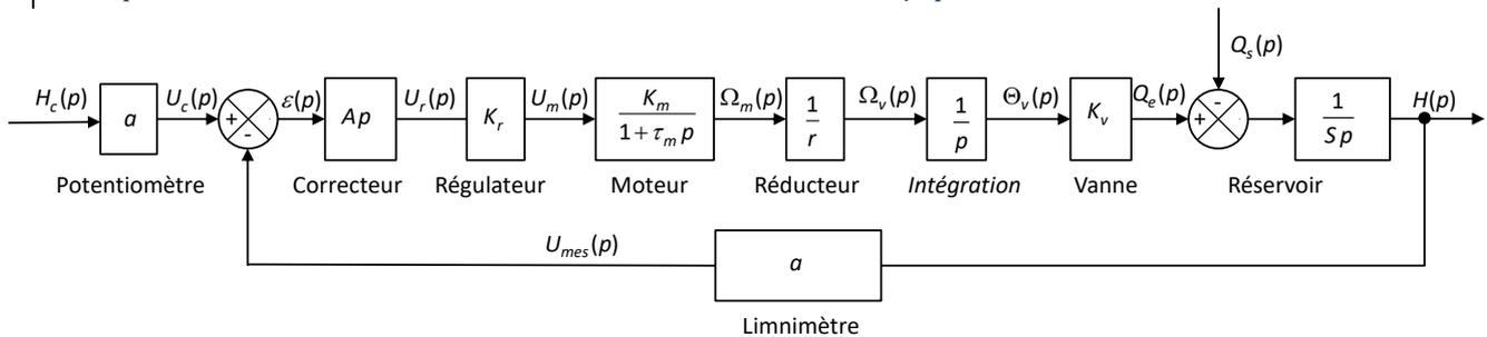
**Q2 :** Déterminer la fonction de transfert  $F_1(p) = \frac{H(p)}{H_c(p)} \Big|_{Q_s(p)=0}$ . Le modèle est-il précis en poursuite ?
